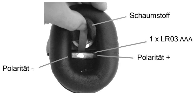
Wenn die Batterien schwach sind, funktioniert der Gehörschutz nicht und die schwachen Außengeräusche werden nicht mehr verstärkt. Dann müssen die Batterien ausgetauscht werden. Befolgen Sie hierfür die Schritte im vorherigen Abschnitt.
