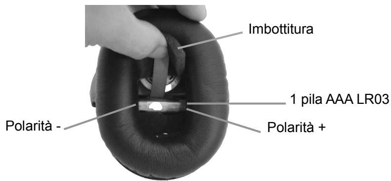
Quando le pile sono scariche, il casco non si mette più in funzionamento ed i suoni esterni deboli non sono amplificati. Bisogna quindi sostituire le pile. Seguire la procedura indicata nella sezione precedente.
