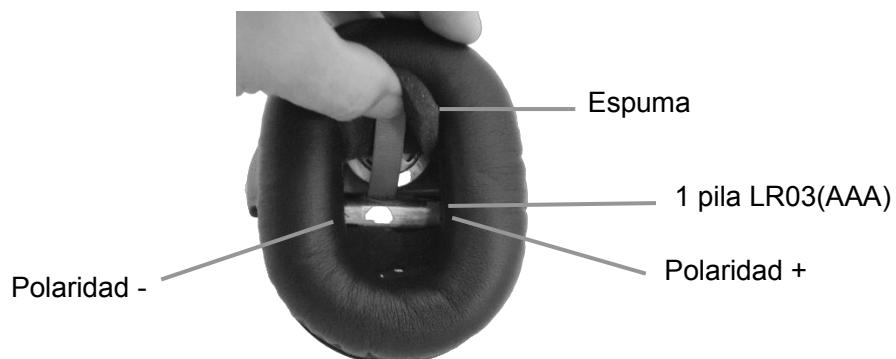
Cuando la carga de las pilas está baja, el casco no se pondrá más en funcionamiento y los sonidos exteriores débiles no serán ampliados más. En tal caso, es preciso sustituir las pilas usadas por pilas nuevas. Siga el procedimiento indicado en el apartado anterior.
