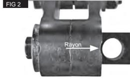
Faites glisser l'ensemble de serrage à levier dans la genouillère et positionnez le trou dans la pince à levier avec le rayon dans la genouillère
