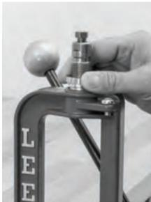
Insérez la douille dans la presse. Ajustez votre matrice vers l'intérieur ou vers l'extérieur pour un fonctionnement correct.
