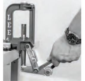
La tringlerie à bascule fonctionne sur des boulons spéciaux de type aéronautique et est maintenue par un contre-écrou à couronne. Vous pouvez régler le contre-écrou pour éliminer tout jeu latéral dans la tringlerie.
