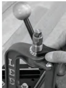
Serrez légèrement la matrice avec la clé à anneau de verrouillage fournie.
