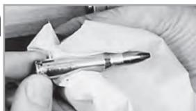
EN CAS DE CHARGEMENT maximal, il est recommandé d'éliminer toute trace de lubrifiant du boîtier avec un chiffon sec. Cela réduira la pression exercée sur le boulon.
