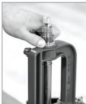
Les balles doivent être placées suffisamment profondément pour traverser le mécanisme de l'arme. Les matrices Lee et Modern Reloading indiquent la longueur totale maximale qui fonctionnera dans toutes les actions standard. Ne placez jamais les balles plus profondément que ce qui est indiqué dans les données de chargement que vous utilisez, à moins de réduire la charge.
