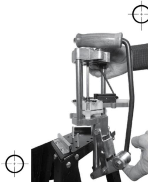
**1** La presse s'adapte directement sur le bloc de base en acier LEE inclus avec le support de rechargement n° 90688 ou la plaque d'établi n° 90251.
