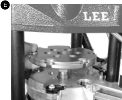
Soulevez le transporteur aux 3/4 de la hauteur. Installez la plaque de coque, tournez dans le sens des aiguilles d'une montre.
