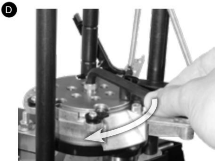
Abaissez le support jusqu'au bas de la course (poignée vers le haut). Avec une clé hexagonale de 1/4 de pouce, tournez la clé dans le sens des aiguilles d'une montre pour desserrer.
