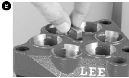
Abaissez le support jusqu'au bas de la course, puis soulevez légèrement la tige d'indexation.
