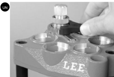
Retirez la matrice de bague de verrouillage de culasse de la station 4 pour accéder à la tige d'indexation.
