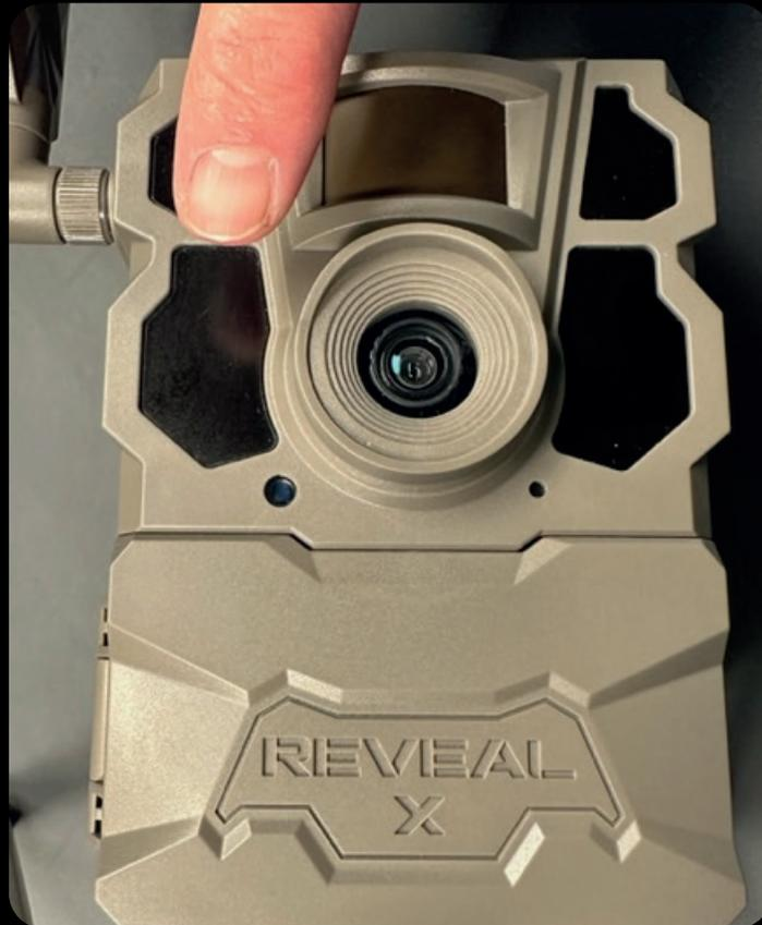
7.1.2. Lorsque la caméra est déclenchée par le mouvement, vous commencerez à recevoir des photos de la caméra. Vous pouvez déplacer votre doigt devant le capteur de mouvement PIR pour déclencher la capture d'une image.
