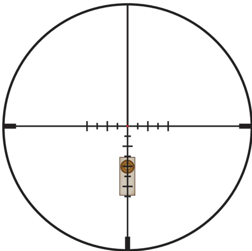
Correction de la chute de balle de 4 MRAD sur le réticule pour un tir de 600 verges de distance. Aucun vent.
