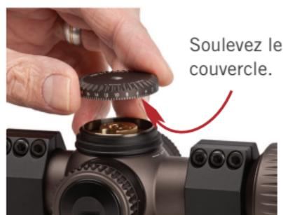
3. Réinstallez le capuchon en le tournant de façon à ce que le repère «0» s'aligne avec le point de référence sur le corps de la tourelle.
